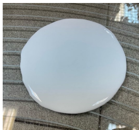
Рис. 6. Испытание литьевых смесей на растекаемость
