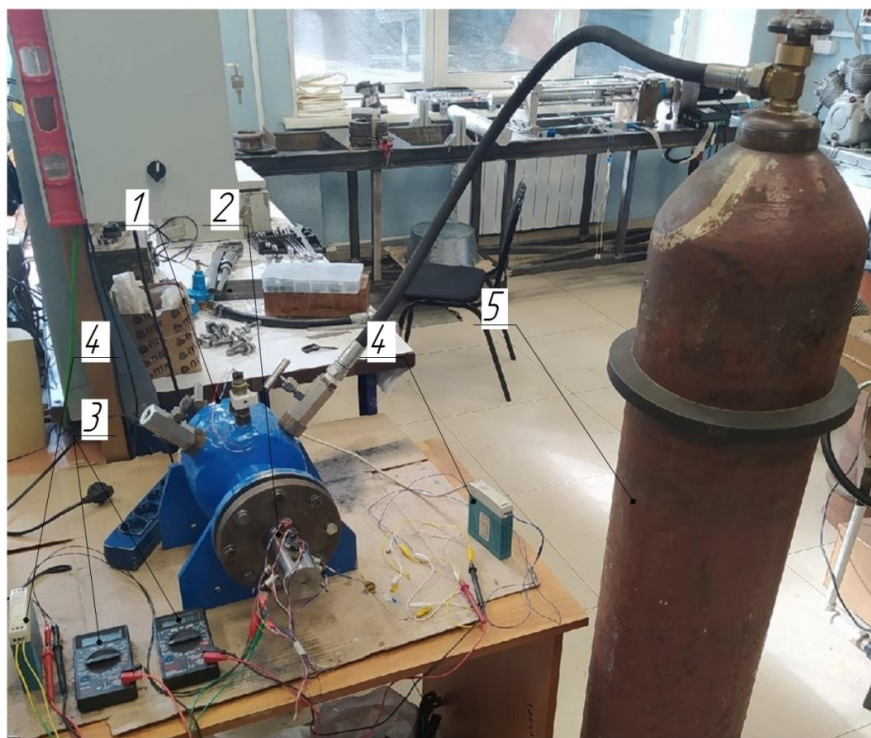
Рис. 5. Общий вид экспериментального стенда: 1 – емкость, 2 – оснастка, 3 – мультиметры, 4 – блок питания, 5 – баллон со сжатым воздухом.
